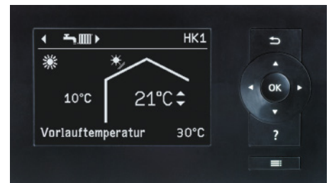
Display der Wärmepumpenregelung Vitotronic 200
